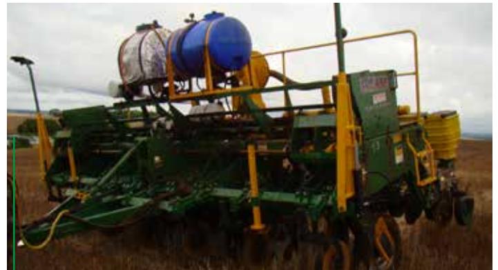
Plantadeiras são adaptadas com tanques, bicos e mangueiras que conduzem os fertilizantes ao sulco de plantio. Técnica permite otimização do tempo de plantio e redução de gastos e perdas.
